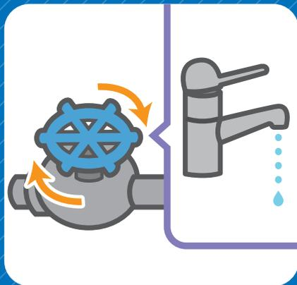
水道の元栓を右に回し、一度完全に閉めて、蛇口を開いても水が出ないことを確認してください。
