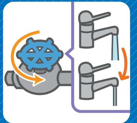
水道の元栓を左に一回り開け、蛇口の水の出を確認してください。最初に確認した際の水量より半分程度になれば完了です。
