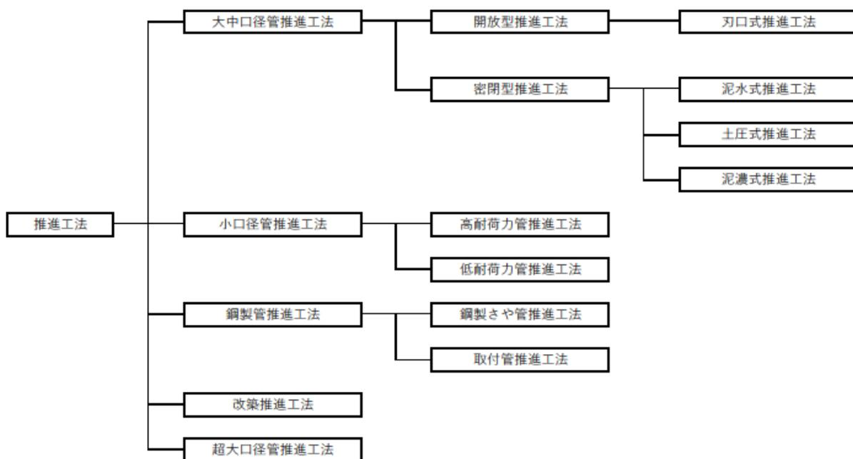
図-10.1 推進工法の分類
