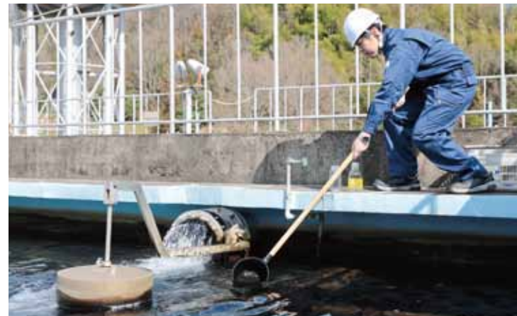
処理水の検査を行うことで、適切に浄水処理が行われているか確認しています。
